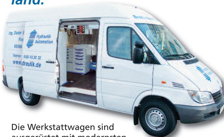
Die Werkstattwagen sind ausgerüstet mit modernsten Messgeräten für Druck, Volumensstrom, Temperatur und Ölservice. Alle gängigen Verschraubungen, Messanschlüsse, Ersatzfilter und Ventile sind an Bord. Hierdurch werden Fehlersuche und vorbeugende Wartungen professionell ausgeführt und Maschinenstillstand auf ein Minimum reduziert.
